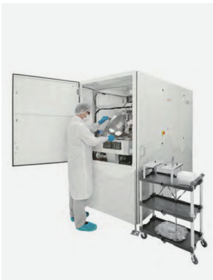
操作员手动将晶圆装入Santis 300 P2系统的loadlock中
